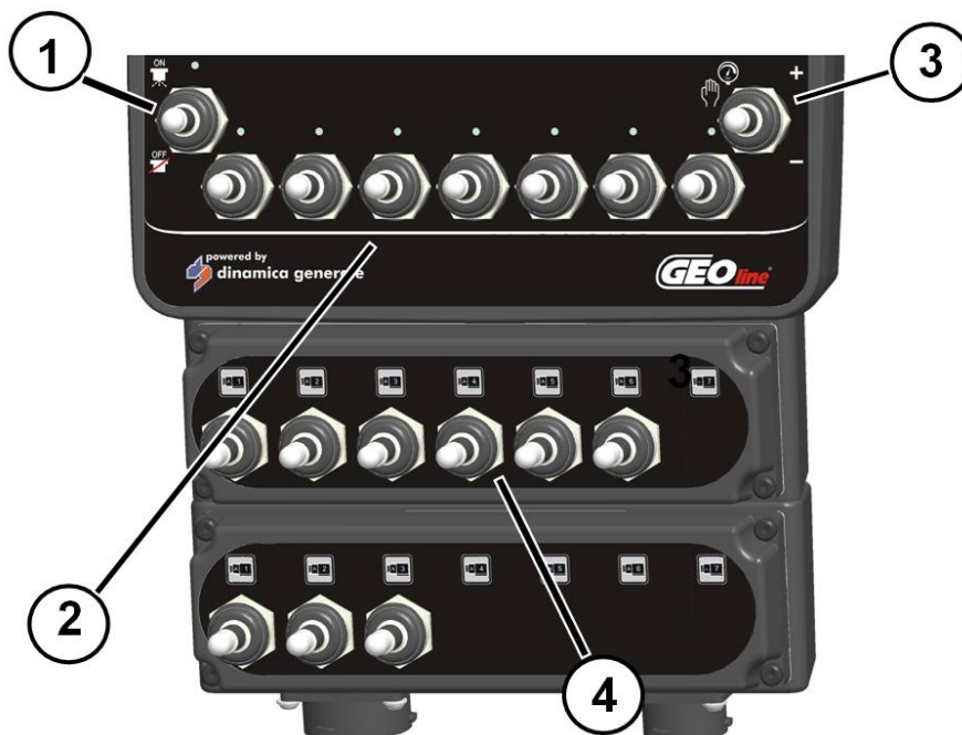
Rysunek 7 – Ułożenie przełączników, wersja olejowo- hydrauliczna
